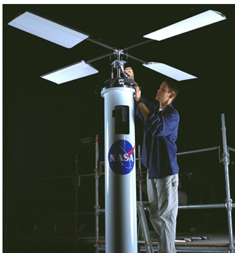
Figure 2. Mars Rotor Hover Test
